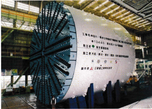
シールドマシン：環状七号線地下調節池
